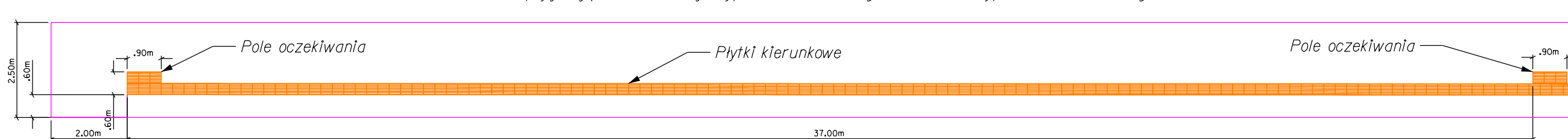
Peron tramwajowy o minimalnej długości 70m (przyjmując dla tramwaju typu 122N-35m długości oraz dla typu 805Na-32m długości)
